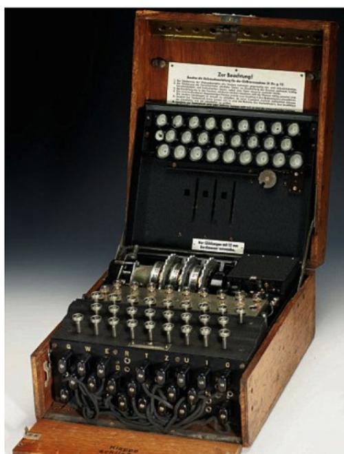
Figure 1 – Une machine Enigma
